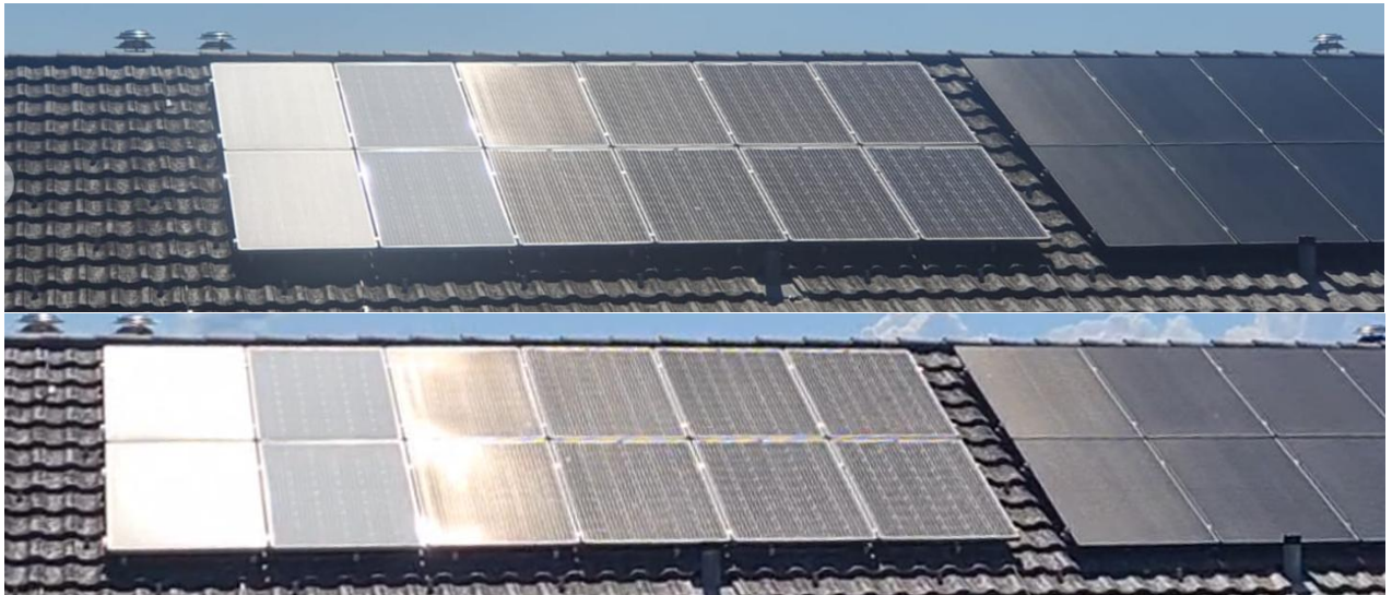
Abbildung 6: Geometrischer Blendpunkt auf dem PV-Print-Modul (ca. 40'000 cd/m 2 ) und auf dem Phytonics-Modul (ca. 16'000 cd/m 2 ). Oben: Messung August 2024, Unten: Messung Mai 2025
