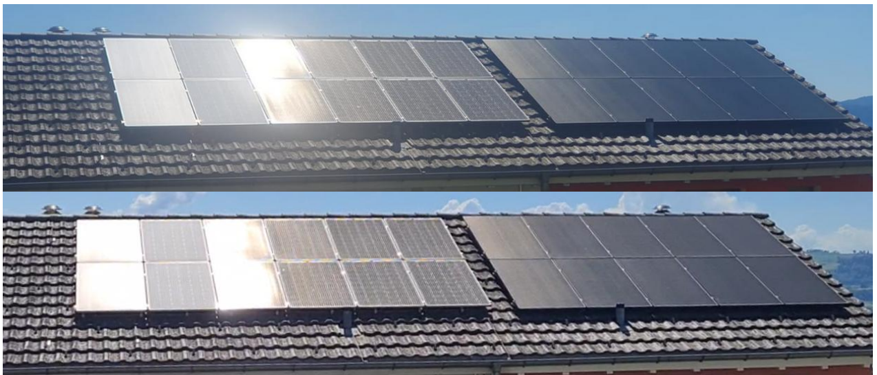
Abbildung 7: Blendpunkt auf dem Standard-Solarmodul (ca. 5'000'000 cd/m 2 ). Oben: Messung August 2024, Unten: Messung Mai 2025
