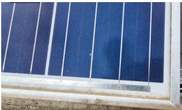
Abbildung 13: Detailbild Standardsolarglas nach 1 Jahr Outdoor-Alterung
