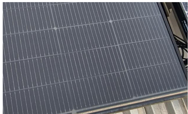
Abbildung 14: Detailbild Glas mit Phytonics-Folie nach 1 Jahr Outdoor-Alterung
